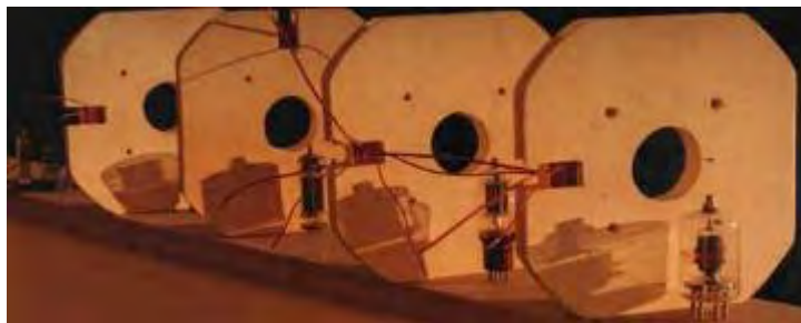
Линейка из четырех трансформаторов. Рядом, для сравнения, поставлены лампы.
