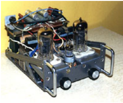
Вариант конструкции "стерео" с полупроводниковым выпрямителем
