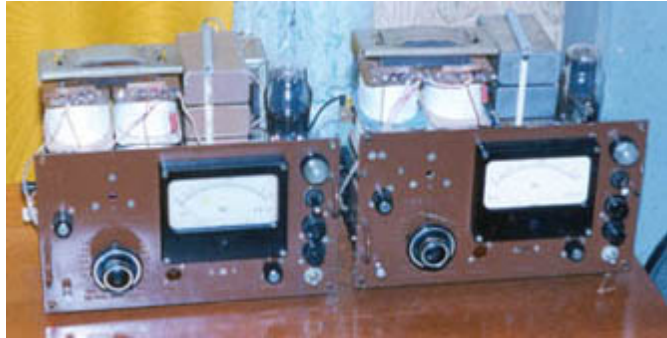
Конструкция моноблоков с кенотронным выпрямителем
