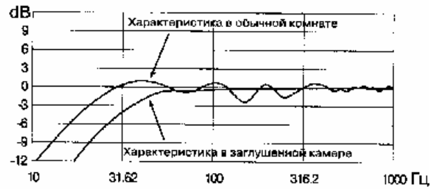
Рис. 4-2. Сравнение амплитудно-частотных характеристик громкоговорителя в заглушенной камере и в обычной комнате
